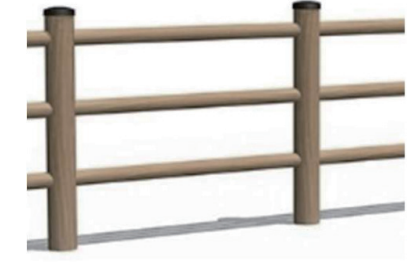
写真11 斜面地部 転落防止柵イメージ
