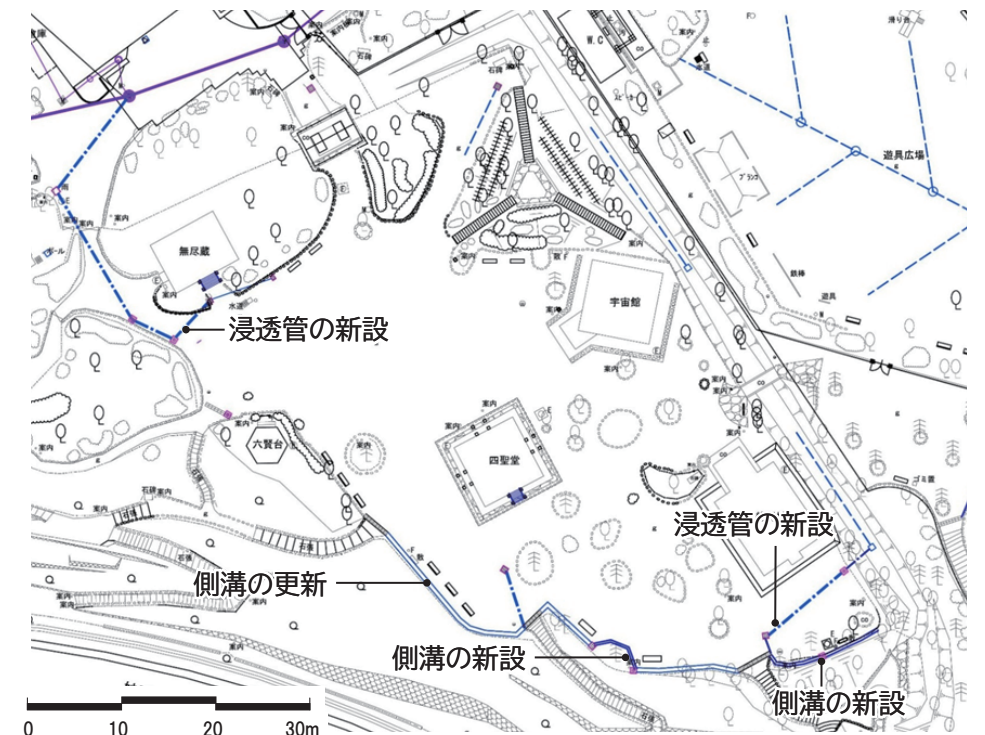
図 34 時空岡周辺 雨水排水設備平面図
