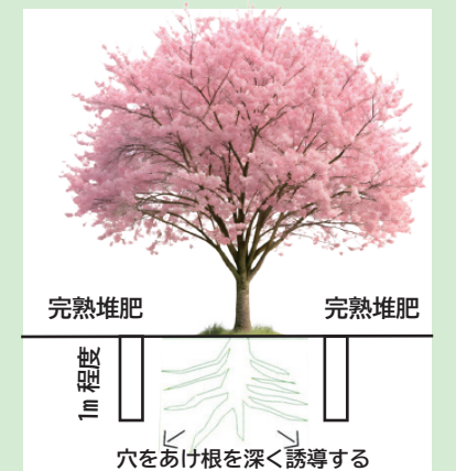
図 10 縦穴式土壤改良法 模式断面図
