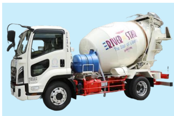
工事車両：コンクリートミキサー車
