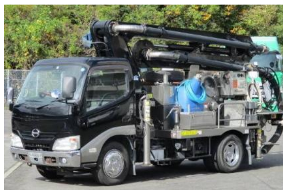
工事車両：コンクリート圧送車
