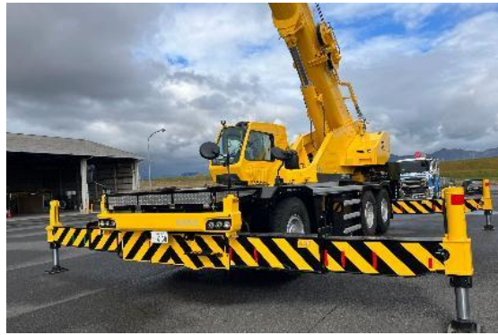
重機：ラフテレーンクレーン
