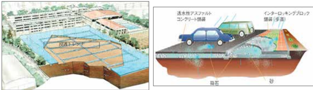
図 6-4. 学校グラウンドに施設設置のイメージ図と 駐車場や歩道の施設設置イメージ図
