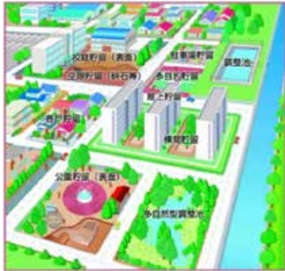
図 6-7. 雨水貯留施設のイメージ図
