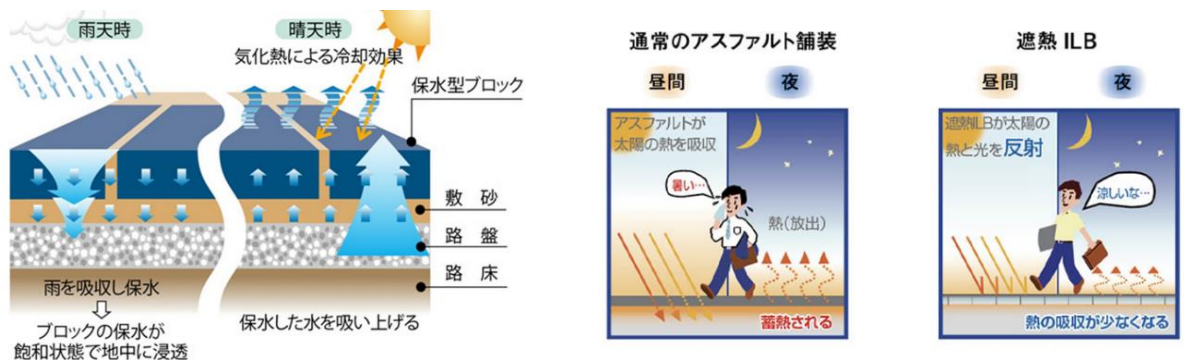
図：保水・遮熱舗装（保水性 ILB、遮熱性 ILB）の効果の例
