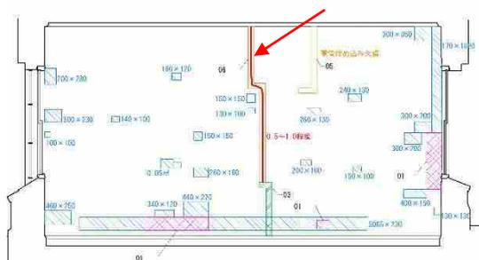
図 3-83 部屋東面（内部）破損図
