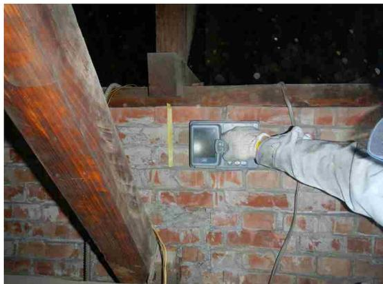
図 2-45 鉄筋探査
