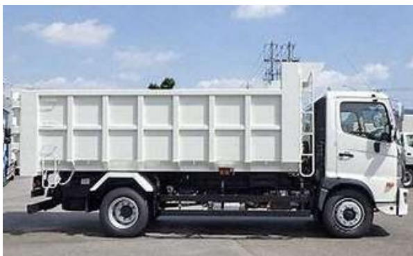
車両名:大型ダンプ車 資材・廃材を運搬する際に 使用します。
