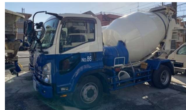
車両名:コンクリートミキサー車 生コンクリート打設時、生コンク リート運搬に使用します。
