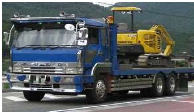
車両名:大型トレーラー 重機や長物の資材を載せて 運搬する際に使用します。
