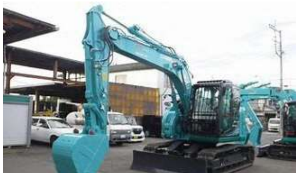
車両名:バックホウ 躯体解体や掘削する際に使用します。
