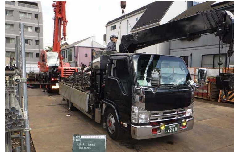
車両名:ユニッククレーン車 トラックにクレーンが付いており、資材を運搬する際に使用します。
