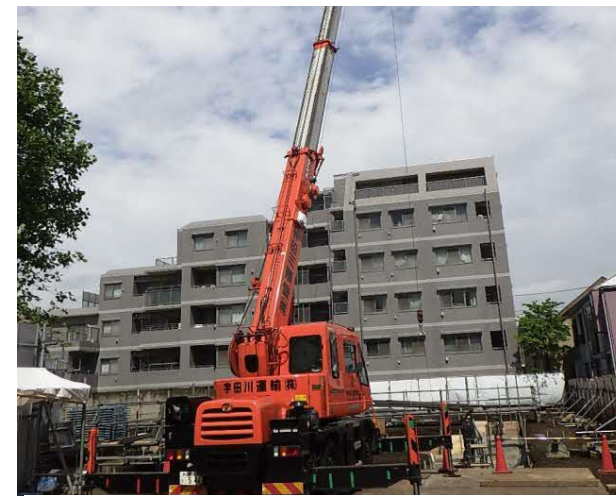
車両名:クレーン車 資材を荷揚げする際に使用します。
