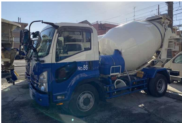
車両名:コンクリートミキサー車 生コンクリートを打設する際に使用します。
