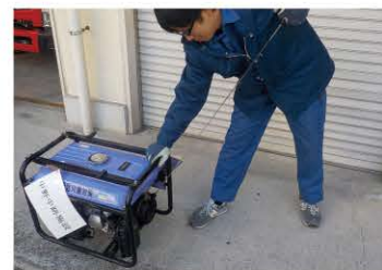
⑤ スターターを一気に引きます。この時、後ろに人がいないか確認しましょう。一度でエンジンがかからない場合は、再度スターターを引きます。
