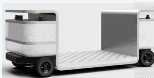
▲少人数型低速移動モビリティ (5km/h、歩道・敷地内走行、自動走行)
