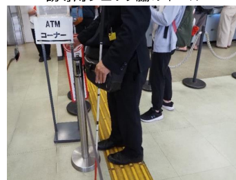
白杖をついた時の離隔も考慮してポールを設置して欲しい
