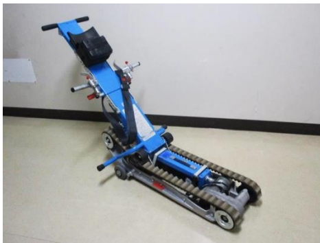
学校に配置された階段昇降機
